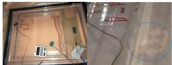
Bild 8: VAP-Infusion - Messung der Infiltrationszeit (links); Infusion kurz bevor vollständiger Imprägnierung (rechts)
